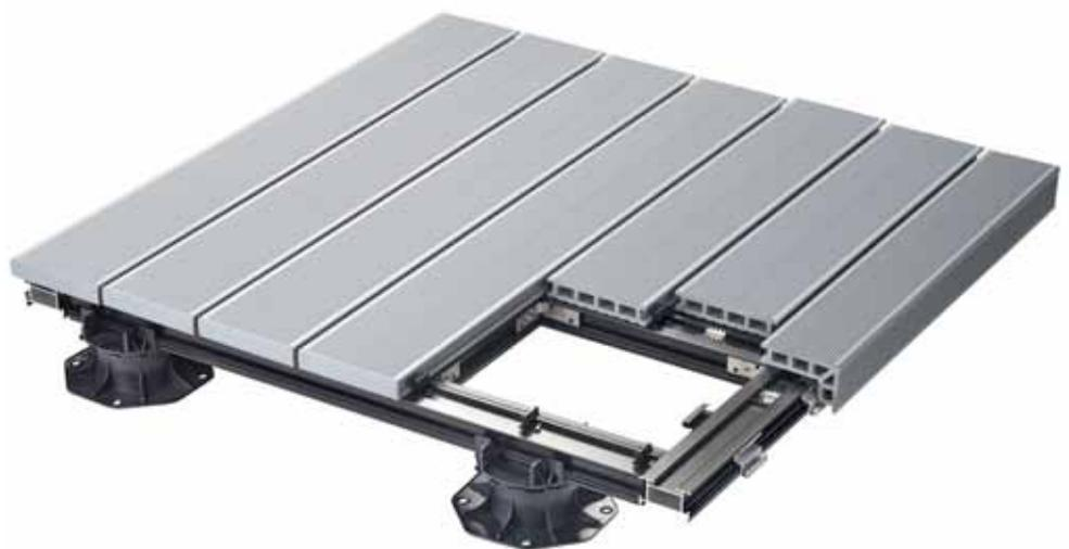
Die gesamte Unterkonstruktion und die komplette Terrasse können ohne Bohren oder Schraubbefestigung montiert werden. Die Terrassendielen werden mit einem Click System verlegt und dabei mit einem einzigartigen Befestigungsclip installiert. Der gewährleistet, dass die Dehnfugen im Laufe der Jahre konstant groß bleiben.
