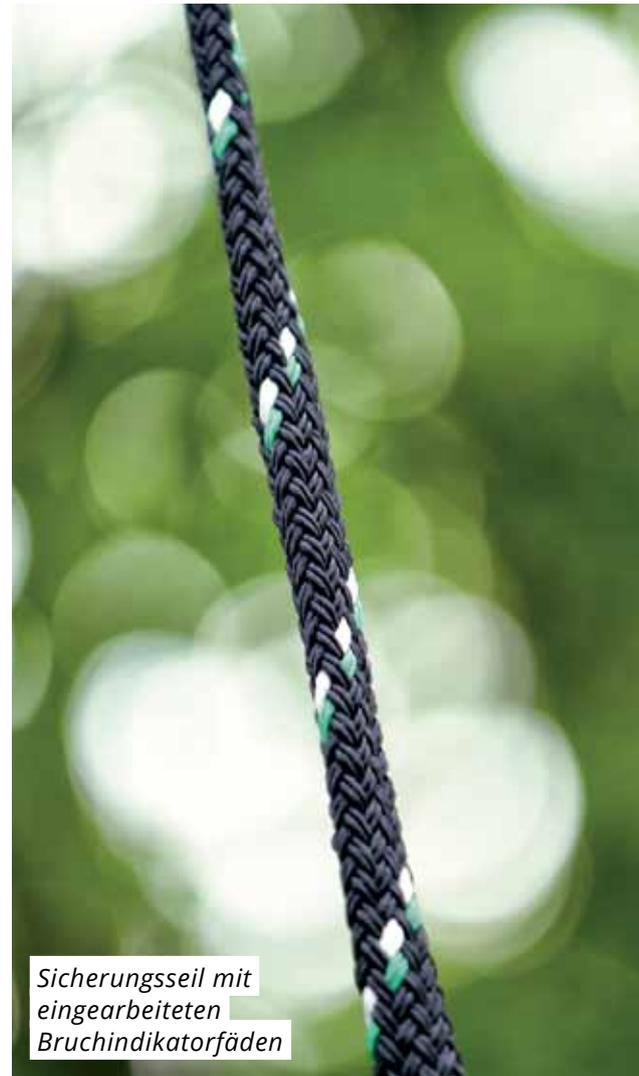
Sicherungsseil mit eingearbeiteten Bruchindikatorfäden
