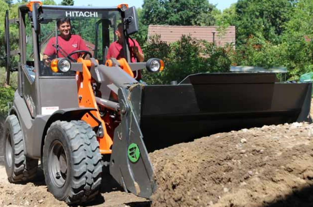
**Material be- und entladen, als Zubringer innerhalb der Baustelle fungieren, Lasten heben und verfahren, Material beistellen und ein starker Unterstützer beim Wegebau und beim Pflastern sein – kurz: als vielseitiger, leistungsstarker Helfer im Einsatz sein. So lautet die Aufgabenbeschreibung für Hitachi-Kompaktrader auf Baustellen im Garten- und Landschaftsbau.**
