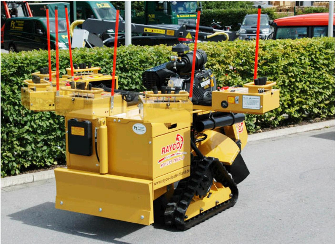
Die Rayco RG 1635 SJR-S ist eine Maschine, die auch unerfahrenen Benutzern eine optimale Handhabung ermöglicht und bietet sich auch für die Vermietung an. Optisch wurde die Kunststoffhaube durch eine Stahlhaube ersetzt. Das Modell RG 1635 SJR-S wird sowohl mit einer 4 –rädigen Gummibereifung als auch mit Gummikettenfahrwerk angeboten.
